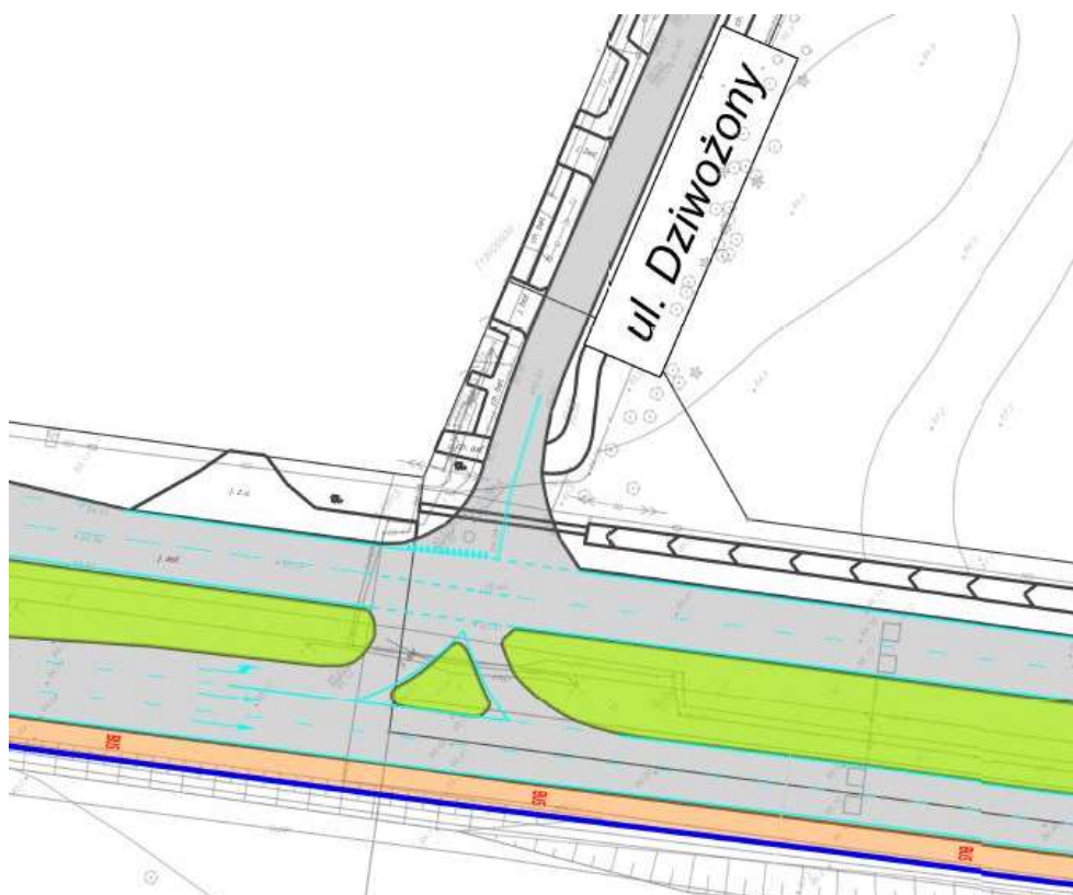
Rys. 5.4. Pas autobusowy na wysokości skrzyżowania bez sygnalizacji świetlnej z ul. Dziwożony – bez zmian w organizacji ruchu – wariant 1a.
